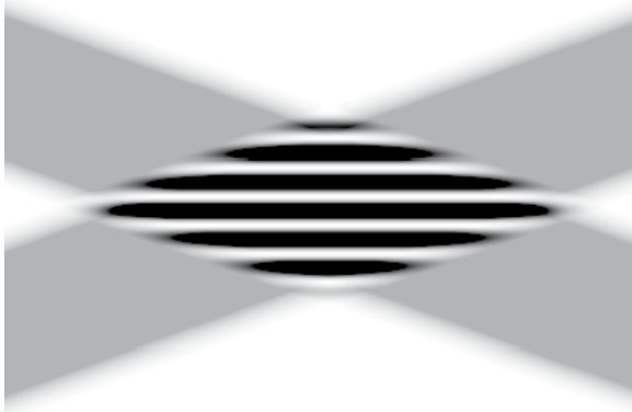
Abb. 4.36 Wie Abb. 4.35, nur ist hier das zeitliche Mittel des Quadrats dargestellt. Man erkennt die Interferenz im Durchkreuzungsbereich der beiden Wellen. Helle Streifen: Auslöschung, dunkle Streifen: Verstärkung
