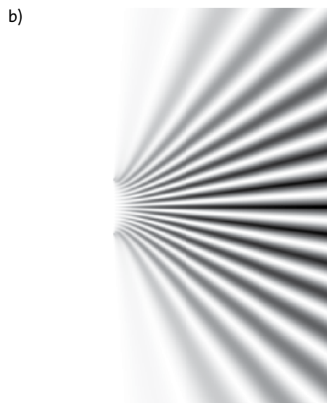
Abb. 5.12 (a) Momentaufnahme der Kugelwellen, die aus zwei kleinen Öffnungen austreten. (b) Mittelwert des Quadrats der Wellenfunktion.
