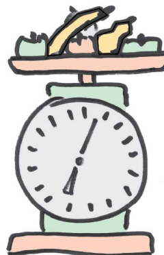
Abb. 6.3 Auf die Frage: „Wie schwer ist das Obst?“ kann die Waage etwa 200 verschiedene Antworten geben. Die Datenmenge einer Antwort ist damit etwa 8 bit.
