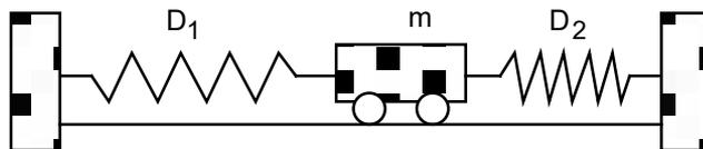
Die Distanz der beiden Wände sowie die Längen der Federn sind gerade so gewählt, dass die beiden Federn entspannt sind, wenn sich der Wagen in der Ruhelage befindet.
