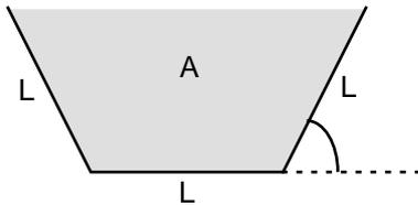
Der Neigungswinkel  $\alpha$  der Seitenwände soll so gewählt werden, dass die Querschnittsfläche  $A$  der Rinne maximal wird.
