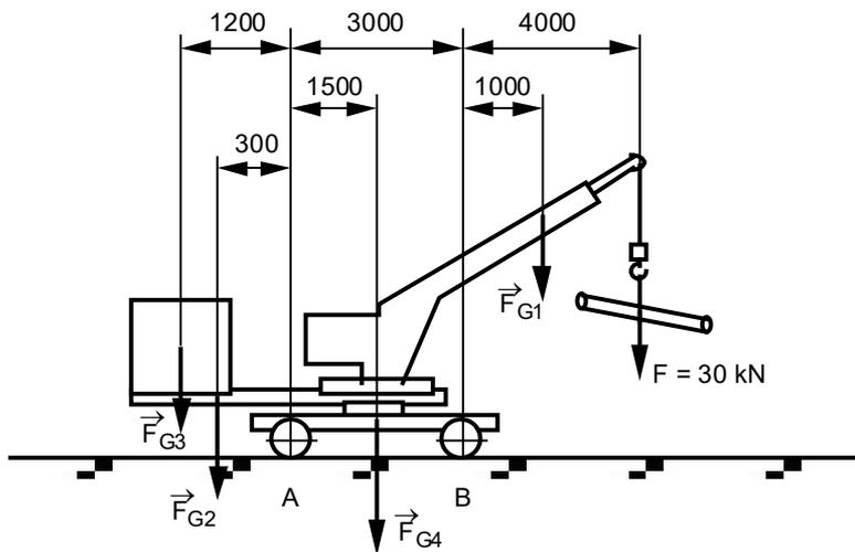
Der Kran hält eine Last vom Betrag  $F = 30 \text{ kN}$ . Die auf den Kran wirkende Gewichtskraft kann in Teilgewichtskräfte aufgeteilt werden. Sie betragen  $F_{G1} = 10 \text{ kN}$ ,  $F_{G2} = 8.0 \text{ kN}$ ,  $F_{G3} = 16 \text{ kN}$ ,  $F_{G4} = 20 \text{ kN}$ . Die Längen sind in der Zeichnung in Millimeter (Fehler  $\pm 1 \text{ cm}$ ) angegeben.
