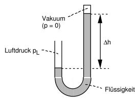
Das linke obere Ende ist offen. Über der Flüssigkeitssäule befindet sich also Luft mit dem Druck  $p_L$ . Das rechte obere Ende ist geschlossen. Über der Flüssigkeitssäule ist der Raum leer (Vakuum, p=0). Rechts steht die Flüssigkeitssäule um  $\Delta h$  höher als links.
