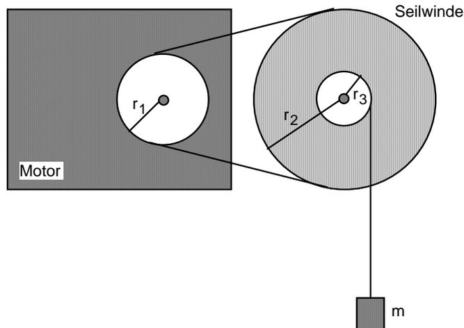
Im technischen Datenblatt steht, dass der Motor ein maximales Drehmoment vom Betrag  $M_{\max} = 500 \text{ Nm}$  hat.
