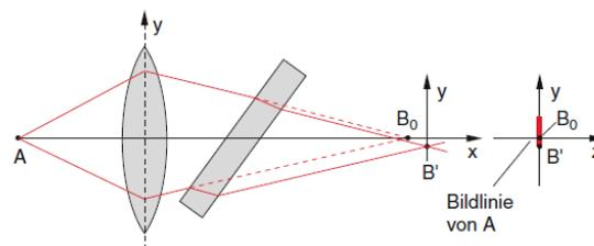
**Abbildung 9.46** Astigmatismus beim schrägen Durchgang eines Lichtbündels durch eine planparallele Platte. Ohne Platte läge das Bild von  $A$  in  $B_0$ . Die Strahlen in einer horizontalen Schnittfläche des Lichtbündels schneiden sich in  $B'$
