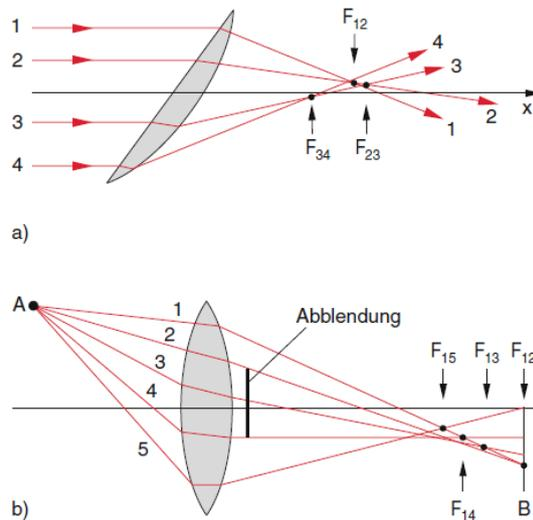
**Abbildung 9.43** a) Koma beim Durchlaufen eines Parallellichtbündels durch eine schiefe Linse. Die einzelnen Teilbündel führen zu räumlich verschiedenen Brennpunkten  $F_i$ . b) Bei der Abbildung eines Punktes  $A$  außerhalb der Symmetrieachse führen die verschiedenen Teilbündel zu unterschiedlichen Bildpunkten  $B_i$
