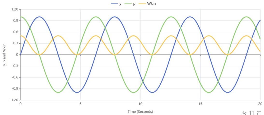
Verwendete Zahlenwerte:  $m = 1 \text{ kg}$ ,  $D = 1 \text{ N/m}$ ,  $\hat{y} = 1 \text{ m}$ ,  $\varphi = 0$
