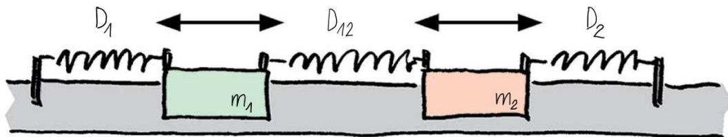
Die Länge der Federn sowie die Distanz zwischen den beiden äusseren Federbefestigungen seien so gewählt, dass alle drei Federn entspannt sind, wenn sich die beiden Schwingkörper in ihren Ruhelagen befinden.
