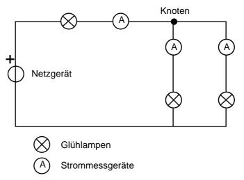
b) Prüfen Sie den **Knotensatz** nach. Variieren Sie dazu die Spannung (gekennzeichneter Drehknopf am Netzgerät), und lesen Sie jeweils die Stromstärken an den Messgeräten ab.
