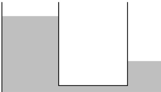
Wir beobachten, dass das Öl vom Gefäss mit der grösseren Füllhöhe in den mit der niedrigeren fliesst, und dass der Vorgang aufhört, wenn in beiden Behältern die gleiche Flüssigkeitshöhe erreicht worden ist.
