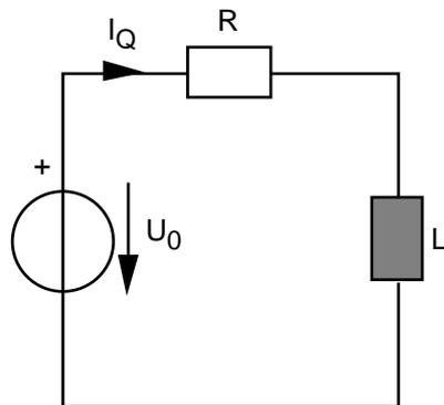
Erstellen Sie mit DYNASYS ein systemdynamisches Modell, mit welchem man den zeitlichen Verlauf des elektrischen Ladungsstromes  $I_Q$  sowie die Spannungen  $U_R$  und  $U_L$  über dem Widerstand und der Spule simulieren kann.
